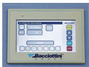
Écran de commande tactile pour effectuer tous les réglages.
