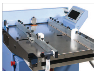
Dispositif d'alimentation à succion par le bas.
