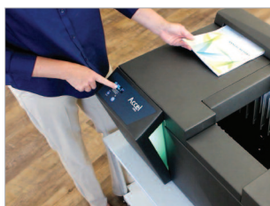
Système permettant de mesurer l'épaisseur de la liasse de feuilles.
