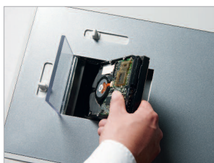
Ouverture réglable par curseur selon le format du disque dur introduit.
