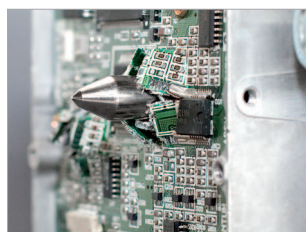
Perforation du disque dur un poinçon en acier trempé nickelé.
