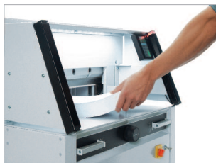
Barrage immatériel par cellules photo-électriques.
