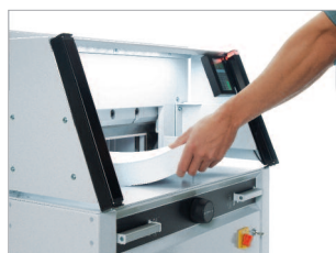
Barrage immatériel par cellules photo-électriques.
