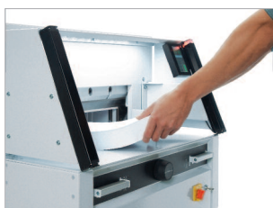
Barrage immatériel par cellules photo-électriques.
