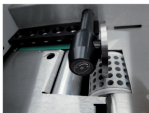
Système d'alimentation à suction par le bas (pas de rupture de flux).
