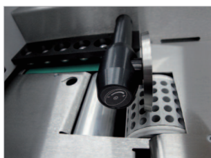
Système d'alimentation à succion par le bas (pas de rupture de flux).
