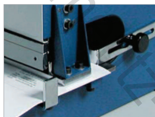
Butée latérales et arrière réglables pour plus de précision.
