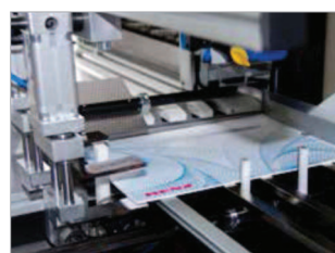
Station d'accumulation des liasses perforées avant reliure.
