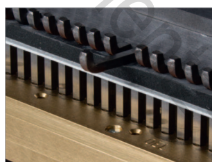
Outils de perforation avec poinçons débrayables (QSA).
