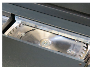
Fraisage des documents pour une meilleure pénétration de la colle.
